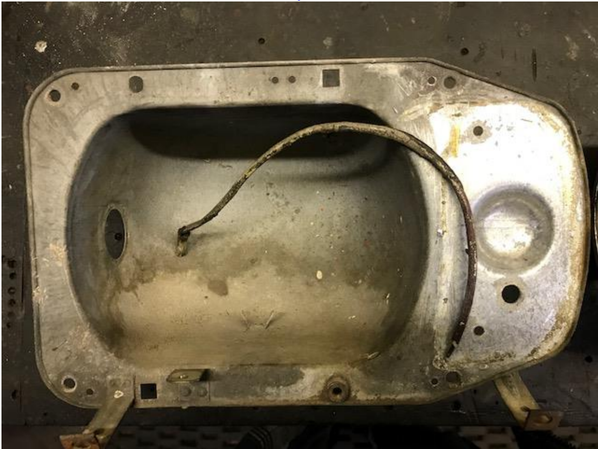
Befestigungs Grundeinheit für Hella – hier fehlt einfach Lichtkegel-Verstellschraube und Blinkergehäuse!
